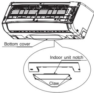
**INSTALLATION AFTER CONNECTION OF REFRIGERATING PIPES**
